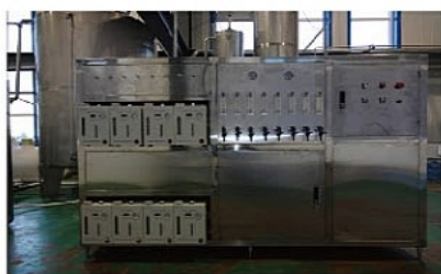
图6 合作研发的应用于矿泉水生产线的溴酸根催化还原设备。
