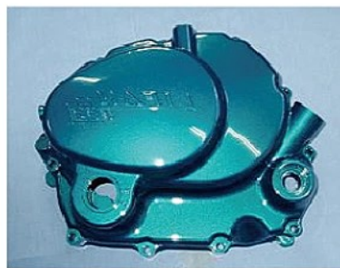
微弧氧化及涂漆后的镁合金部件
