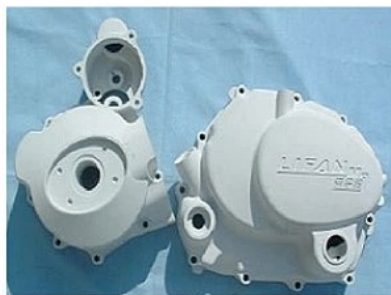
微弧氧化及涂漆后的镁合金部件
