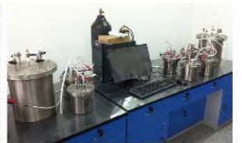
图4 模拟膨润土/间隙水环境中金属腐蚀的原位电化学测量
