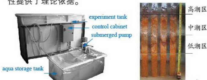
图6 在潮差模拟实验装置内腐蚀72d的Q235B钢表面形貌
